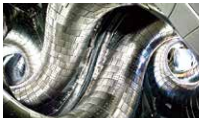
大型ヘリカル装置 (LHD) 真空容器
