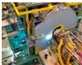
40倍のルミノシティ増強を目指して運転を開始したSuperKEKB加速器と Belle II測定器 ©KEK
