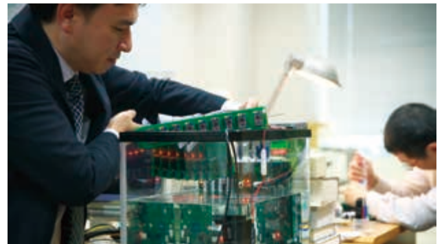
水没コンピュータと故障診断用の試験片を水に沈める冷却試験の様子
