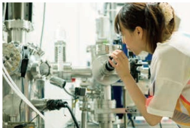
X線光電子分光による物性解析 不安定化合物のX線光電子分光による物質の電子状態解析と物性評価
